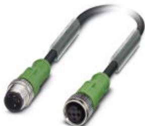
Кабель для датчика / исполнительного элемента, 3-полюсн., PUR без галогенов, темно-серый RAL 7021, Штекеры прямое M12, A-кодирование, к Гнездо прямое M12, A-кодирование, длина кабеля: 10 м
