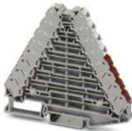
Распределительная панель, без нажимной кнопки, номинальное напряжение: 250 В, номинальный ток: 8 А, сечение: 0,14 мм<sup>2</sup> - 2,5 мм<sup>2</sup>, AWG: 14 - 26, тип подключения: Зажимы Push-in, полюсов: 2, количество подключений: 32, ширина: 8,3 мм, длина: 100 мм, цвет: серый, цвет элементов подключения: белый, красный, монтаж: NS 35/7,5, NS 35/15
