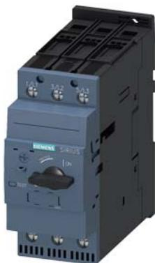
Автоматический выключатель, типоразмер S2 для защиты двигателя, класс срабатывания 10 Максимальный расцепитель тока с обратозависимой выдержкой времени 35–45 А N-расцепитель 650 А Винтовой зажим Повышенная коммутационная способность
