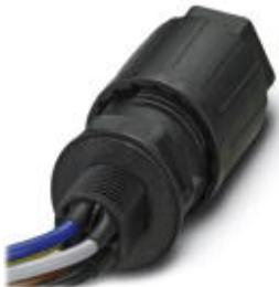
Проходная деталь QUICKON для взрывоопасных областей, кол-во контактов 4+PE, 1,0 мм<sup>2</sup>... 2,5 мм<sup>2</sup> / с гайкой QUICKON, черной, для кабеля диаметром 9 мм ... 16 мм, соединительная резьба M20 с 5 приваренными жилами 2,5 мм<sup>2</sup>, длиной 0,5 м, концы ровно обрезаны.
