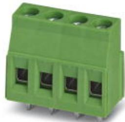
Клеммы для печатной платы, номинальный ток: 24 A, номинальное напряжение: 400 В, размер шага: 5,08 мм, полюсов: 10, тип подключения: Винтовой зажим с натяжной гильзой, монтаж: Пайка волной припоя, направление подключения, проводник/печатная плата: 0 °, цвет: зеленый. Возможна установка в ряд модулей с различным количеством полюсов (контактов)!
