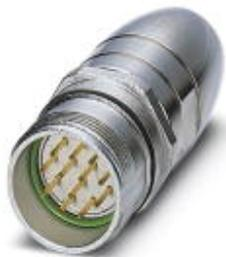
Переходной соединитель, прямой, экранирован.: есть, Винтовой зажим, M23, Полюсов: 12, тип контактов: Штифт, Обжим, диапазон диаметра кабеля: 3 мм ... 10,5 мм
