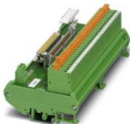
16-канальный модуль для компонентов Honeywell C300. Управление модулем осуществляется по цепи управления, подключаемой с помощью 37-полюсного разъема D-SUB или 50-полюсного FLK. Со стороны подключения полевых устройств предусмотрен винтовой зажим (1+, 1-,...16+,16-) с ножевым разъединителем. Ширина модуля: 170 мм
