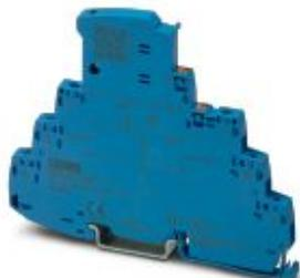
Устройство защиты от перенапряжений, со встроенным индикатором состояния и ножевыми размыкателями для 2-проводной сигнальной цепи Ex i без потенциала земли, напр. токовых контуров 0(4) ... 20 mA, поддержка HART.
