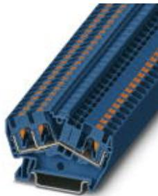
Проходные клеммы, номинальное напряжение: 800 В, номинальный ток: 32 А, тип подключения: Зажимы Push-in, количество точек подсоединения: 3, сечение: 0,2 мм<sup>2</sup> - 6 мм<sup>2</sup>, AWG: 24 - 10, ширина: 6,2 мм, цвет: синий, тип монтажа: NS 35/7,5, NS 35/15
