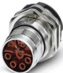
Приборный соединитель, задняя часть стенки, прямой, экранирован.: есть, для стандартной блокировки и SPEEDCON, M23, Полосов: 8+4+PE, тип контактов: Розетка, Обжим, Плоское уплотнение, Центральное крепление M26 x 1, Толщина стенок, мин.: 1,5 мм, Толщина стенок, макс.: 5 мм
