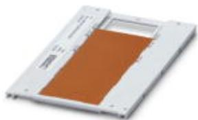
Вставная табличка, со встроенным транспондером RFID-UHF, Пластина, оранжевый, без маркировки, маркируется с помощью: BLUEMARK ID COLOR, BLUEMARK ID, BLUEMARK CLED, тип монтажа: крепление в держателе маркировки, размер маркировочного поля: 90 x 38 мм
