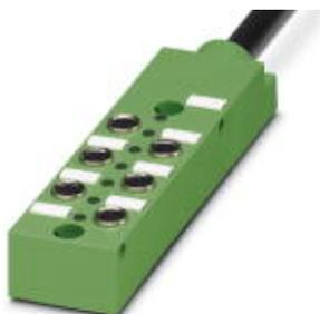
Коробка датчика и исполнительного элемента, применение: Стандартн., тип подключения: Розетка M8 металл, количество гнезд: 6, полюсов: 3, механические ключи: А - стандарт, гнездо для платы: один ряд, индикатор состояния: есть, р-п-р; подключение магистрального кабеля: Жесткое подключение 180°, PUR/PVC, длина кабеля: 5 м, экранировка: нет
