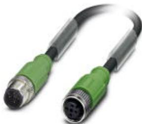
Кабель для датчика / исполнительного элемента, 4-полюсн., PUR/ПВХ, темно-серый RAL 7021, экранирован., Штекеры прямое M12, А-кодирование, к Гнездо прямое M12, А-кодирование, длина кабеля: 0,6 м
