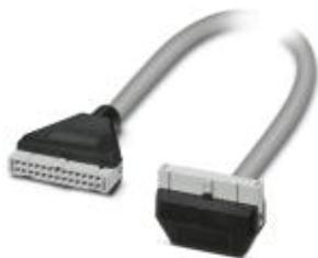
Подготовленный круглый кабель; Подключение 1: IDC/FLK коммутационная плата (1x 26-полюсн., 180 °-Отвод); Подключение 2: IDC/FLK коммутационная плата (1x 26-полюсн., 90 °-отвод); длина кабеля: 1 м
