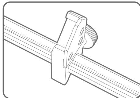
2 Установите упорную планку согласно отрезаемой длине.
