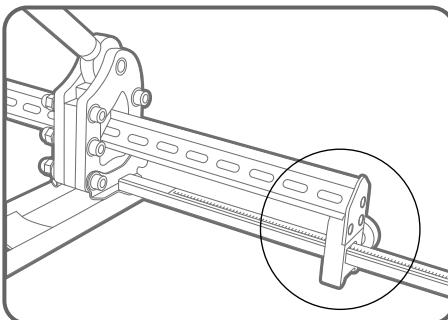
3 Приподнимите рукоятку и установите DIN-рейку до упора в планку.
