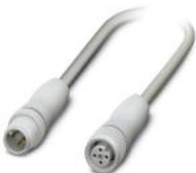
Кабель для датчика / исполнительного элемента, 4-полюсн., PP-EPDM без галогенов, серый RAL 7035, Штекеры прямое M12, А-кодирование, к Гнездо прямое M12, А-кодирование, длина кабеля: 3 м, Гигиеничный дизайн, с пластмассовой накатанной гайкой
