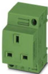
Розетка, Схема расположения контактов тип G, Винтовые зажимы, для Великобритании и других стран, с расширенной защитой от прикосновения / заслонкой, зеленый, для монтажа на несущую рейку и в интерфейсе обслуживания или прямого монтажа, 250 В AC, 13 А, -20 °C, 60 °C, BS 1363-1/-2
