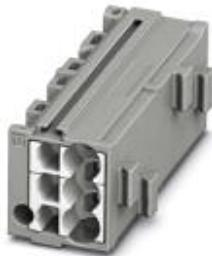
Сотовые клеммы, без нажимной кнопки, номинальное напряжение: 500 В, номинальный ток: 17,5 А, сечение: 0,14 мм<sup>2</sup> - 2,5 мм<sup>2</sup>, AWG: 14 - 26, тип подключения: Зажимы Push-in, полюсов: 1, количество подключений: 6, ширина: 11 мм, длина: 12,2 мм, цвет: серый, цвет элементов подключения: белый, монтаж: крепление защелками на адаптере для монтажной рейки, крепление защелками на фланце крышки
