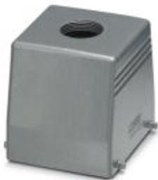
Сальниковый корпус HEAVYCON B32, крепление производится двумя защелками, высота 80 мм, с резьбой 1x M40, прямое подключение кабеля
