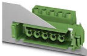
Проходной штекер, номинальный ток: 76 А, расчетное напряжение (III/2): 1000 В, полюсов: 2, размер шага: 10,16 мм, тип подключения: Винтовой зажим с натяжной гильзой, цвет: зеленый, поверхность контакта: Серебро
