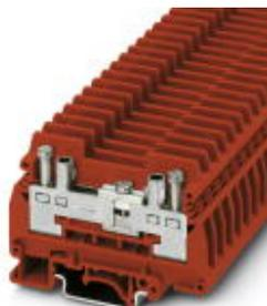
Измерительная клемма с ползунковым размыкателем, со скользящей перемычкой, тип подключения: Винтовые зажимы, сечение: 0,5 мм<sup>2</sup> - 10 мм<sup>2</sup>, AWG: 20 - 10, ширина: 8,2 мм, тип монтажа: NS 35/7,5, NS 35/15, NS 32, цвет: красный
