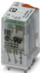
Вставное промышленное реле с силовыми контактами, 2 переключающих контакта, тестовая кнопка, светодиодный индикатор состояния, механический индикатор коммутационного положения, входное напряжение: 24 В В AC
