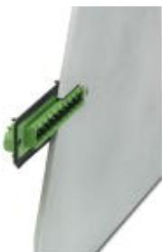
Компоненты для проходного монтажа, номинальный ток: 12 А, расчетное напряжение (III/2): 320 В, полюсов: 6, размер шага: 5,08 мм, цвет: зеленый, поверхность контакта: олово, монтаж: Пайка волной припоя
