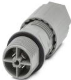
Проходная деталь, Тип подключения QUICKON, полюсов: 4, 1 мм<sup>2</sup> ... 2,5 мм<sup>2</sup>, 20 A, серый, с гайкой QUICKON, диапазон диаметра кабеля: 6 мм ... 10 мм, монтажная резьба: M25, Подкл. плоского штекера, 2,5 мм<sup>2</sup>
