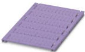
Маркировка для клеммных модулей, Пластина, фиолетовый, без маркировки, маркируется с помощью: TOPMARK NEO, TOPMARK LASER, BLUEMARK ID COLOR, BLUEMARK ID, BLUEMARK CLED, THERMOMARK PRIME, THERMOMARK CARD 2.0, THERMOMARK CARD, тип монтажа: крепление в высоких пазах для табличек, для клемм шириной: 5,2 мм, размер маркировочного поля: 4,6 x 10,5 мм
