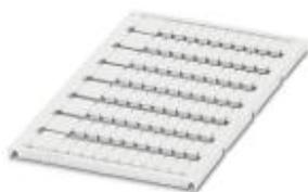
Маркировка для клеммных модулей, Пластина, белый, без маркировки, маркируется с помощью: BLUEMARK CLED, BLUEMARK LED, CMS-P1-PLOTTER, PLOTMARK, тип монтажа: крепление в высоких пазах для табличек, для клемм шириной: 5 мм, размер маркировочного поля: 9 x 4 мм
