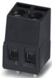
Клеммы для печатной платы, номинальный ток: 17,5 А, номинальное напряжение: 400 В, размер шага: 5,08 мм, полюсов: 2, тип подключения: Винтовой зажим с натяжной гильзой, монтаж: Пайка волной припоя, направление подключения, проводник/печатная плата: 0 °, цвет: черный. Разъемы снабжены внутренней перемычкой
