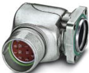
Аппаратн. соединитель, передняя стенка, угловой, поворотный, Винтовой зажим, M23, полюсов: 12, тип контактов: Розетка, Обжим, Аксиальное уплотнительное кольцо, 4x Ø 3,2, экранирован.: есть, размер фланца: 28 мм x 28 мм
