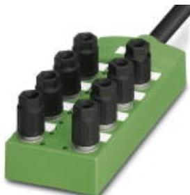
Коробка датчика и исполнительного элемента, применение: Стандартн., тип подключения: QUICKON, 0,14 мм<sup>2</sup> ... 0,34 мм<sup>2</sup>, количество гнезд: 8, полюсов: 3, гнездо для платы: один ряд, индикатор состояния: есть, р-п-р; подключение магистрального кабеля: Жесткое подключение 180°, PUR/PVC, длина кабеля: 10 м, экранировка: нет
