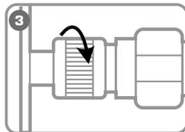
**3** Плотно затяните гильзу БРС, приложив достаточное усилие (без применения слесарного инструмента)
