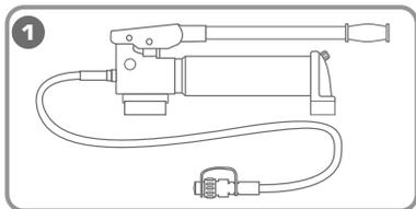
**1** Установите насос по возможности на ровной, плоской поверхности. Такое положение обеспечит устойчивость во время работы
