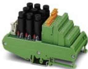
Модуль VARIOFACE, для 8 каналов с дополнительными клеммами плюс и минус. Для каждого канала предусмотрен предохранитель (блок 5 x 20 мм) и индикатор неисправности предохранителя. Разрыв сигнальной цепи производится ножевым размыкателем.
