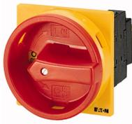
Главные выключатели, 3-полюсн. + N + 1 Замыкающие контакты + 1 Размыкающие контакты, 32 А, Функция аварийного выключения, запираемый в положении 0, Монтаж
