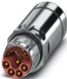
Переходной соединитель, прямой, длинный, экранирован.: есть, для стандартной блокировки и SPEEDCON, M23, Полюсов: 8+4+PE, тип контактов: Штифт, Обжим, диапазон диаметра кабеля: 7,5 мм ... 18 мм
