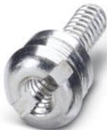
Фиксирующий винт, резьба 4-40 UNC, для применения при монтаже на заднюю стенку, макс. толщина корпуса 1,5 мм
