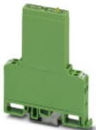
Полупроводниковое реле ввода, со световым индикатором и защитной схемой во входной и выходной цепи, вход: 110 В пост.тока, выход: 4 - 48 В пост.тока/макс. 100 мА
