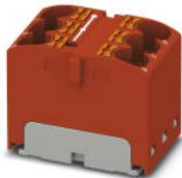
Распределительный блок, с внутренней перемычкой, Блоки можно шунтировать между собой, используя отверстия клеммы. Подходящие перемычки см. в принадлежностях, номинальное напряжение: 450 В, номинальный ток: 32 А, тип подключения: Зажимы Push-in, количество точек подсоединения: 6, сечение: 0,2 мм<sup>2</sup> - 6 мм<sup>2</sup>, AWG: 24 - 10, ширина: 18,5 мм, высота: 22,7 мм, цвет: красный, тип монтажа: склеивание
