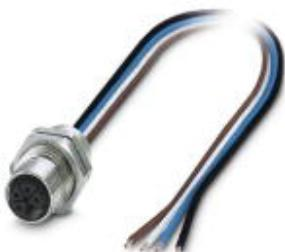
Встраиваемые разъемы, Мощность, 4-полюсн., Гнездо, M12, L - Power, Монтаж с внутренней стороны, M16 x 1,5, Отдельные проводники, длина кабеля: 0,2 м
