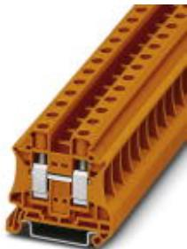
Проходные клеммы, номинальное напряжение: 1000 В, номинальный ток: 57 А, тип подключения: Винтовые зажимы, количество точек подсоединения: 2, сечение: 0,5 мм<sup>2</sup> - 16 мм<sup>2</sup>, AWG: 20 - 6, ширина: 10,2 мм, цвет: оранжевый, тип монтажа: NS 35/7,5, NS 35/15
