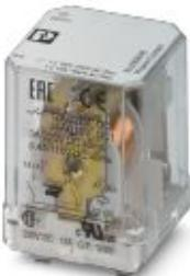
Вставное реле с силовыми контактами, для коммутации высоких нагрузок пост. тока, 1 замыкающий контакт, дугогасительная катушка, напряжение на катушке: 220 В DC
