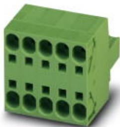
Разъемы для печатной платы, номинальный ток: 41 А, расчетное напряжение (III/2): 1000 В, полюсов: 12, размер шага: 7,62 мм, тип подключения: Пружинные зажимы Push-in, цвет: зеленый, поверхность контакта: олово
