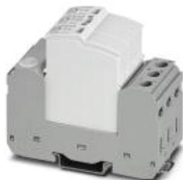
Вставной разрядник защиты от перенапряжений без тока утечки для 2-пол. изолированных и заземленных систем с линейной рабочей характеристикой до 380 В пост. тока, монтаж на DIN-рейке, 3-полюсный базовый элемент с контактом удаленного оповещения, три вставных варистора с контролем температуры, индикаторы состояния на каждом штекере.
