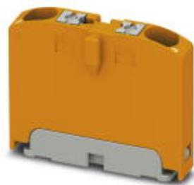
Распределительный блок, Основная клемма, номинальное напряжение: 450 В, номинальный ток: 24 А, тип подключения: Зажимы Push-in, количество точек подсоединения: 2, сечение: 0,14 мм<sup>2</sup> - 4 мм<sup>2</sup>, AWG: 26 - 12, ширина: 5,2 мм, высота: 21,7 мм, цвет: оранжевый, тип монтажа: крепление защелками на адаптере для монтажной рейки
