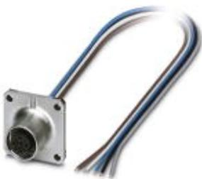
Встр. гнездо для датчика/исп. устр-ва, 5-конт., M12, с мех. ключом В, монтаж на передней панели/с помощью квадратных фланцев, с гибким проводом 0,5 м (TPE), 5 x 0,34 мм<sup>2</sup>
