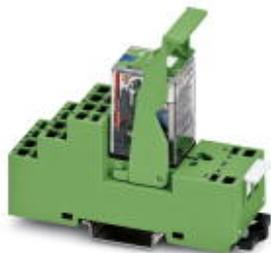
Предварительно смонтированный релейный модуль с пружинными зажимами, состоящий из установочного блока (основания), вставного реле для промышленного применения со светодиодным индикатором и кнопкой включения / отключения с фиксатором, защитного модуля с варистором и выталкивателя реле. Входное напряжение: 120 В AC, 2 переключающих контакта, 10 А
