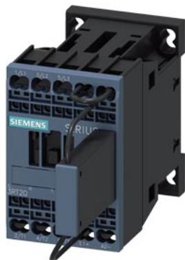
Тяговый контактор, AC-3 12 A, 5,5 кВт/400 В 110 В DC, 0,7–1,25\*US со встроенным помехоподавляющим диодом 3-пол., типоразмер S00 пружинная клемма пригоден для выходов ПЛК без возможности установки вспомогательного выключателя
