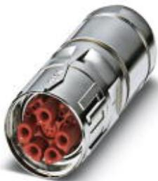
Кабельный соединитель, прямой, длинный, экранирован.: есть, Крепление SPEEDCON, M40, Полюсов: 8+4+PE, тип контактов: Розетка, Обжим, диапазон диаметра кабеля: 20,5 мм ... 26,5 мм
