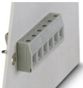
Проходная клемма, тип подключения: Винтовые зажимы, Подключение пайкой, полюсов: 1, ток нагрузки: 32 A, сечение: 0,2 mm<sup>2</sup> - 6 mm<sup>2</sup>, AWG 24 - 10, угол между направлениями подключения провода и установки разъема: 0 °, ширина: 10 mm, цвет: серый
