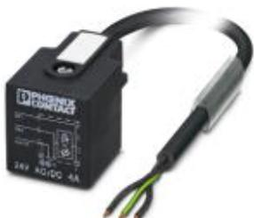
Кабель для датчика / исполнительного элемента, 3-полюсн., ПВХ, черный RAL 9005, свободный конец, к Штекер типа А для электромагнитного клапана, с 1 светодиод, подключение с помощью Варистор, длина кабеля: 10 м
