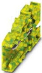
Соединитель COMBI, номинальное напряжение: 500 В, номинальный ток: 24 А, тип подключения: Пружинный зажим, количество точек подсоединения: 1, полюсов: 1, сечение: 0,08 мм<sup>2</sup> - 4 мм<sup>2</sup>, AWG: 28 - 12, ширина: 5,2 мм, высота: 21,8 мм, цвет: желто-зел.
