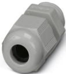
Кабельный ввод, материал резьбового соединения: PA, наружный диаметр кабеля 4 мм ... 8 мм, экранировка: нет, резьба соединительной части: M16 x 1,5, цвет: светло-серый, RAL 7035
